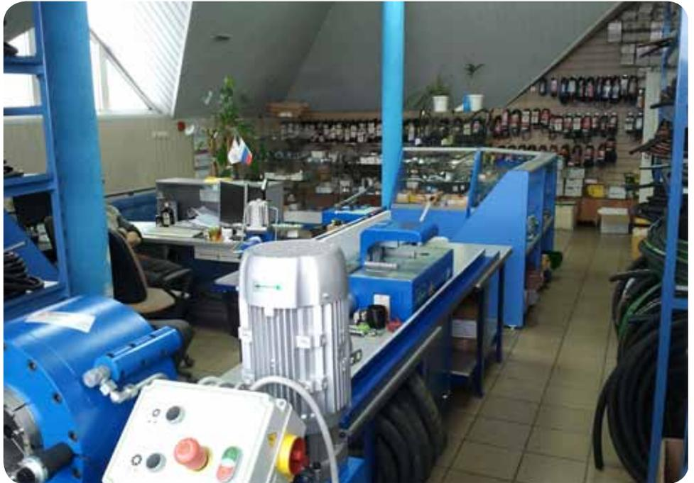
временной линией итальянского оборудования компании OP S.r.l, которая включает опрессовочный, окорочный, отрезной станок позволяющие изготавливать 4-х навивочные рукава до 2" и промышленные рукава до 3" с любыми фитингами, а также трубогиб и станок для предварительной установки врезных колец, с помощью которых можно осуществлять монтажные работы с трубами диаметром от 6 до 42 мм.
