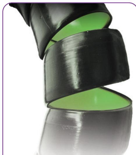
**4. Защитная двухцветная спираль ASTA** предназначена для работы в горнодобывающей отрасли. Спираль содержит антистатическую добавку, предотвращающую появление статического электричества. Цветной индикатор, в виде внутреннего зеленого слоя позволяет определить, износилась спираль или нет и в случае износа вовремя заменить ее. Данную защиту мы советуем использовать на открытых узлах гидросистем.
