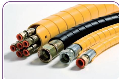
**1. Пластиковая защитная спираль Safelast** бывает черного и желтого цвета, она предназначена для защиты гидравлических и пневматических рукавов от механических повреждений, а также обеспечивает лучшую обзорность рукава при монтаже и обслуживании. Это особенно важно при работе на лесозаготовке или в шахте, когда риск обрыва рукава возрастает в несколько раз. Пластиковая спираль также может быть использована в аэропортах для защиты рукавов для подачи топлива.
