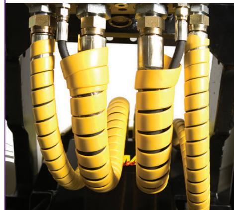
**2. Гибкая спираль** изготавливается аналогично защитным спиральям, но имеет более узкий шаг и более тонкую стенку. Благодаря этому она легче устанавливается, но обеспечивает более низкую степень защиты.
