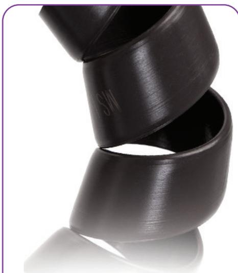
**3. Защитная спираль для горного дела** изготавливается путем компрессии и содержит антистатическую добавку, предотвращающую появление статического электричества. Наличие специальных добавок предотвращает воспламенение и замедляет горение в случае возникновения пожара. Данная спираль специально разработана для использования в шахтах.
