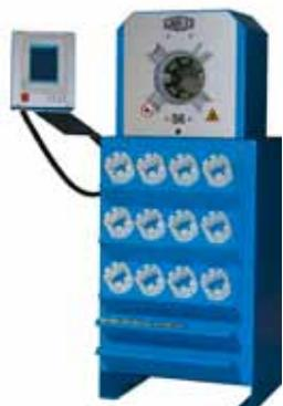
Пресс Uniflex S 6.2 - оптимальное решение для организации мелкосерийного производства РВД. С помощью данного опрессовочного станка можно изготавливать РВД  $\varnothing$  до 2".
