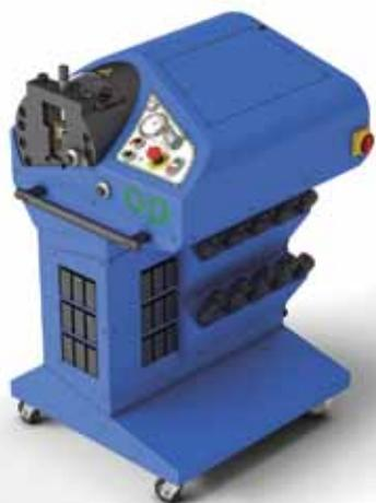
ется в развальцовке трубы методом плавной раскатки по окружности. Эта машина за несколько минут позволит вам произвести развальцовку трубы под соединение типа ORFS с углом 90°. В то же время, данный станок позволяет вам изготовить соединение по типу JIC. Для этого за считанные секунды вам необходи-
