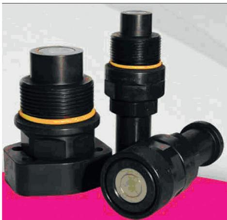
Серия БРС Flat Face VEP-ND FLANG предназначена для работы в тяжелых условиях с высоким операционным давлением, импульсным давлением, механическими нагрузками. Запатентованная система тройного клапана позволяет безопасно соединить две части даже при высоком остаточном давлении. Порт включает внутреннюю резьбу: BSP, NPT и SAE.
