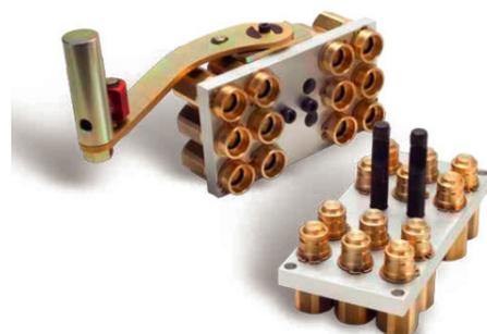
Серия GRE является многопрофильной связующей системой, предназначенной для ручного подключения / отключения нескольких схем одновременно. Серия GRE предназначена для систем отопления, горячей воды, пневматики с рабочим давлением до 10 бар. Серия GRE доступна в конфигурации 6, 12 или 18 муфт, установленных на пластину.
