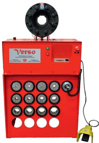
У компании Verso srl обновился парк опрессовочных станков – появились новые модели, с которыми мы хотим вас познакомить. Модели VS25 ММ, VS 25М, VS 32М, VS 32МТ, VS 50М, VS 50МТ и абсолютно новый пресс – VS 50ECQ6, способный обжимать рукава диаметром до 2" – R13, R15, в том числе и буровые.
