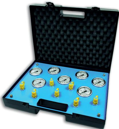
Минимальный набор для качественной диагностики гидросистем состоит из манометров, измерителей потока и температуры масла.
