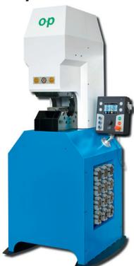
Данный станок предназначен для опрессовывания изделий, имеющих нестандартную форму, например рукавов для гидроусилителей руля автомобилей, рукавов автомобильных кондиционеров.
