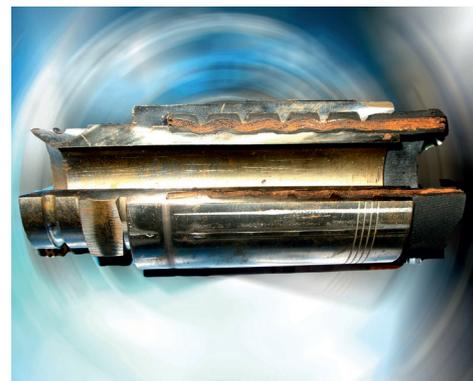
Как видно из среза, зубья муфты при опрессовке прорезали наружный резиновый слой рукава и четко вошли в оплетку рукава, при этом между зубьями отсутствует пустота, внутренний диаметр фитинга деформирован равномерно практически вдоль всей рабочей длины муфты.
